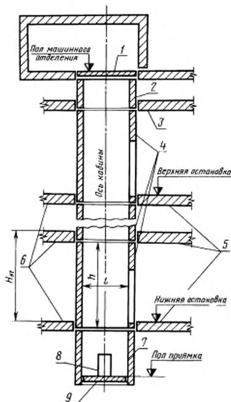
1 — плита перекрытия над шахтой лифта; 2 — верхний блок; 3 — чердачное перекрытие; 4 — средние блоки; 5 — лестничные площадки; 6 — междуэтажные перекрытия; 7 — нижний блок; 8 — тумба под буфер кабины; 9 — плита пола приемки;
